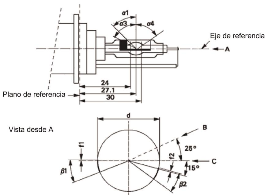
Al medir la distribución de la luminancia del arco en la sección transversal central, tal como se define en la ficha DxR/6, después de girar la fuente luminosa para que la banda negra cubra el arco, la luminancia medida será ≤ 0,5 % de Lmax.
