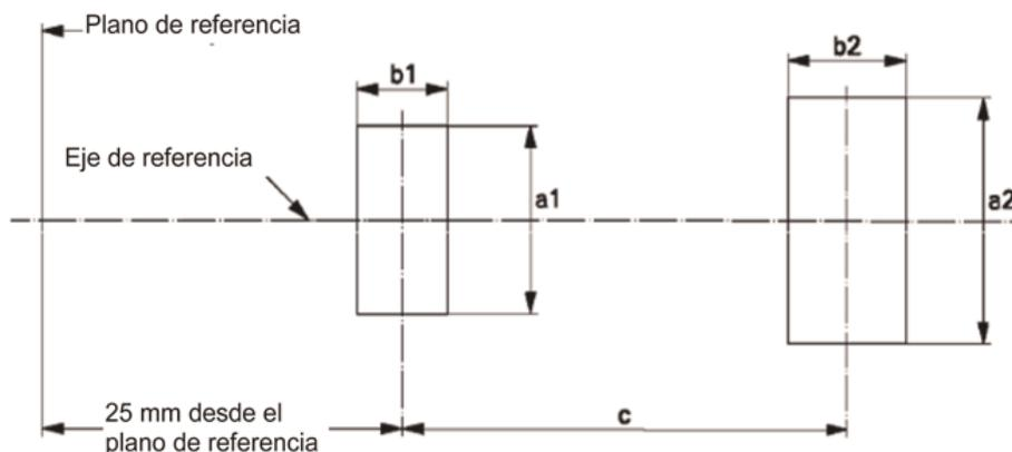
Dirección de medición: vista lateral y superior de la fuente luminosa
