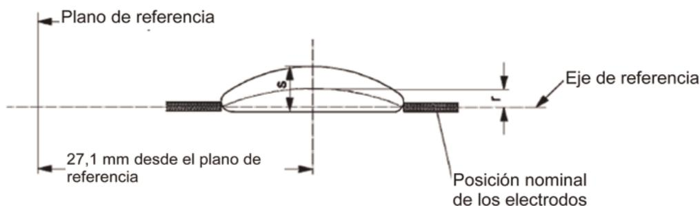
Al medir la distribución relativa de la luminancia en la sección transversal central, tal como se ilustra en el dibujo superior, el valor máximo se encontrará a una distancia  $r$  del eje de referencia. El punto correspondiente a un 20 % del valor máximo se encontrará dentro de  $s$ .
