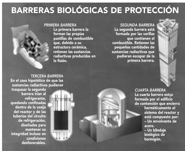
Figura 1. Barreras físicas de protección frente a la radiación en una central nuclear
