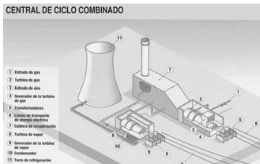
Figura 4. Esquema de una central de ciclo combinado (Fuente: UNESA)
