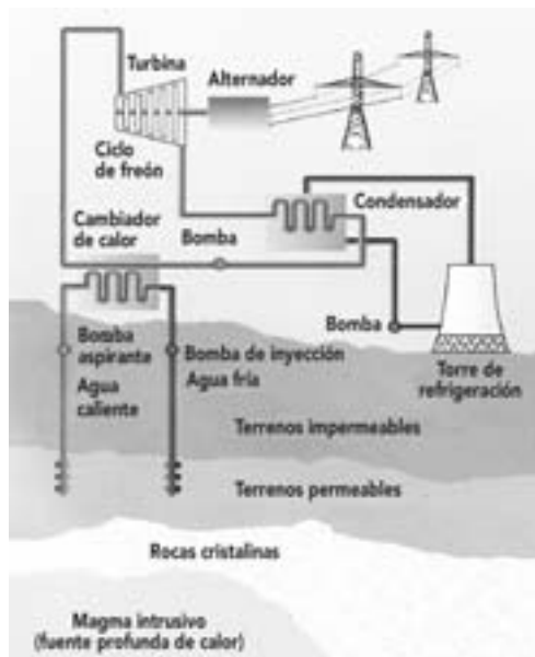
Figura 8. Esquema de funcionamiento de una central geotérmica
