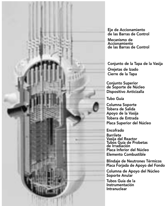
Figura 6. Vasija de un reactor PWR
