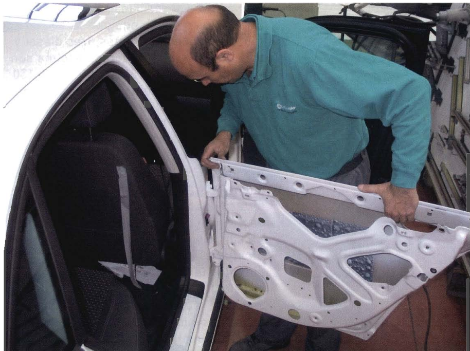
◁ Desmontaje de la puerta
