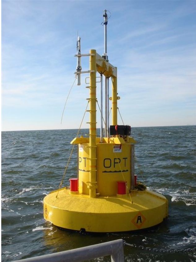
PowerBuoy prototipo instalado en EE.UU.
