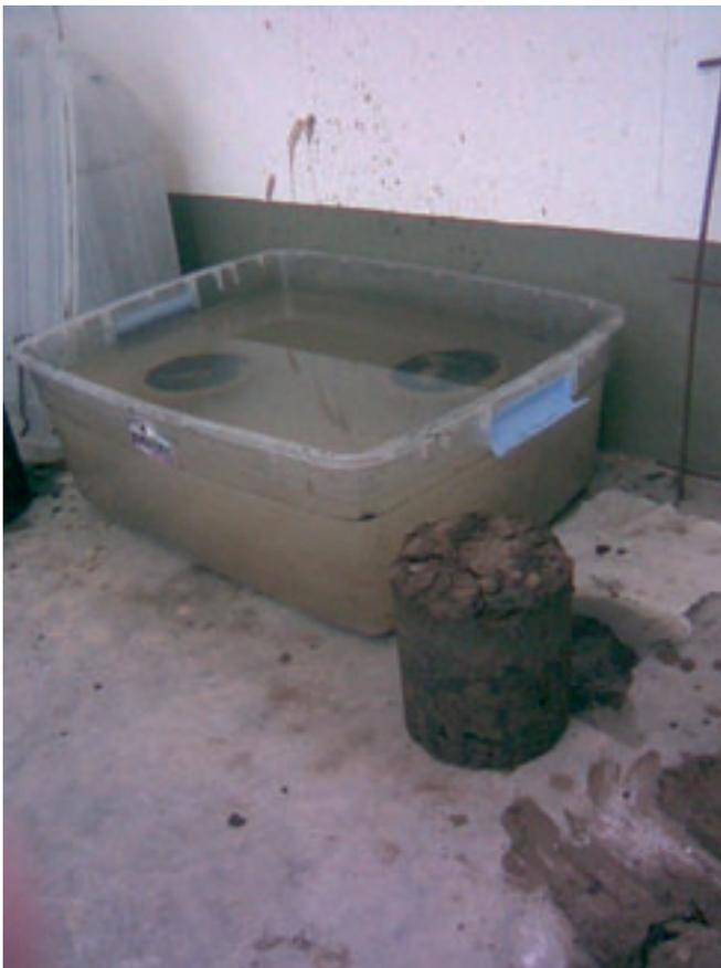
Figura 13. Fotografía Ensayo a la Absorción de agua.
