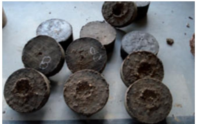
Figura 15. Fotografía Probetas ensayadas a la Abrasión Hídrica.
