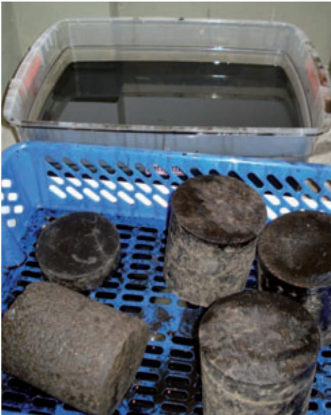
Figura 10. Probetas sumergidas en aceite.
