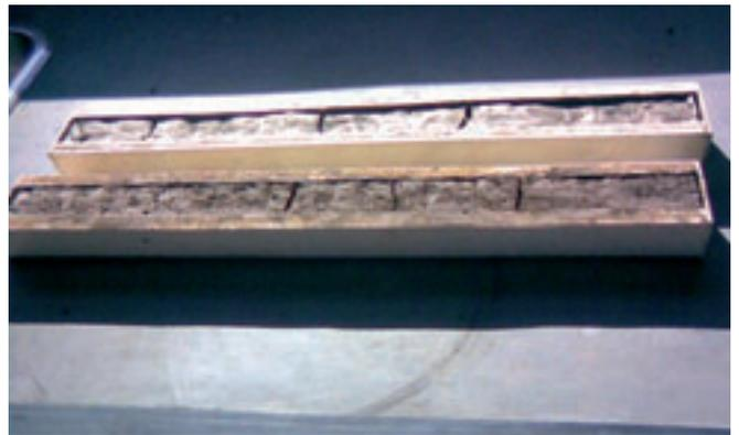
Figura 17. Fotografía probetas ensayadas a la contracción lineal según Alcock.
