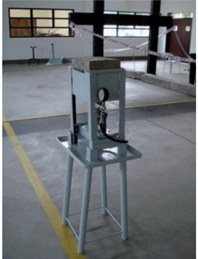
Figura 38. Fotografía de la máquina bloquera con un bloque listo.
