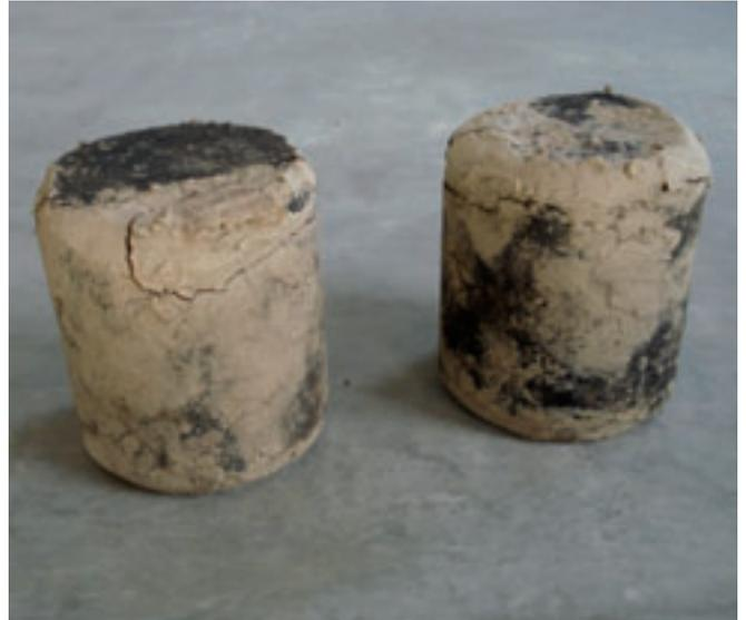
Figura 14. Probetas ensayadas a la Absorción de Agua.
