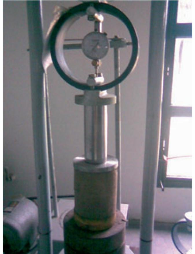
Figura 11. Fotografía probeta dispuesta para ensayo a la Compresión.
