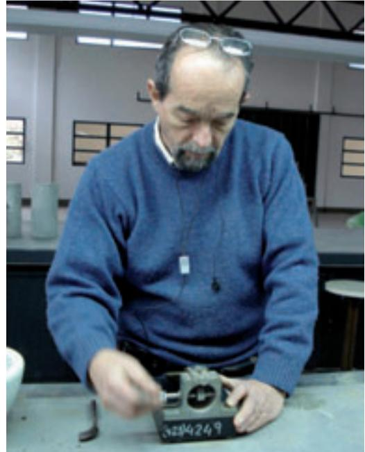
Figura 6. Fotografía ensayo de laboratorio para la determinación del Límite Líquido.
