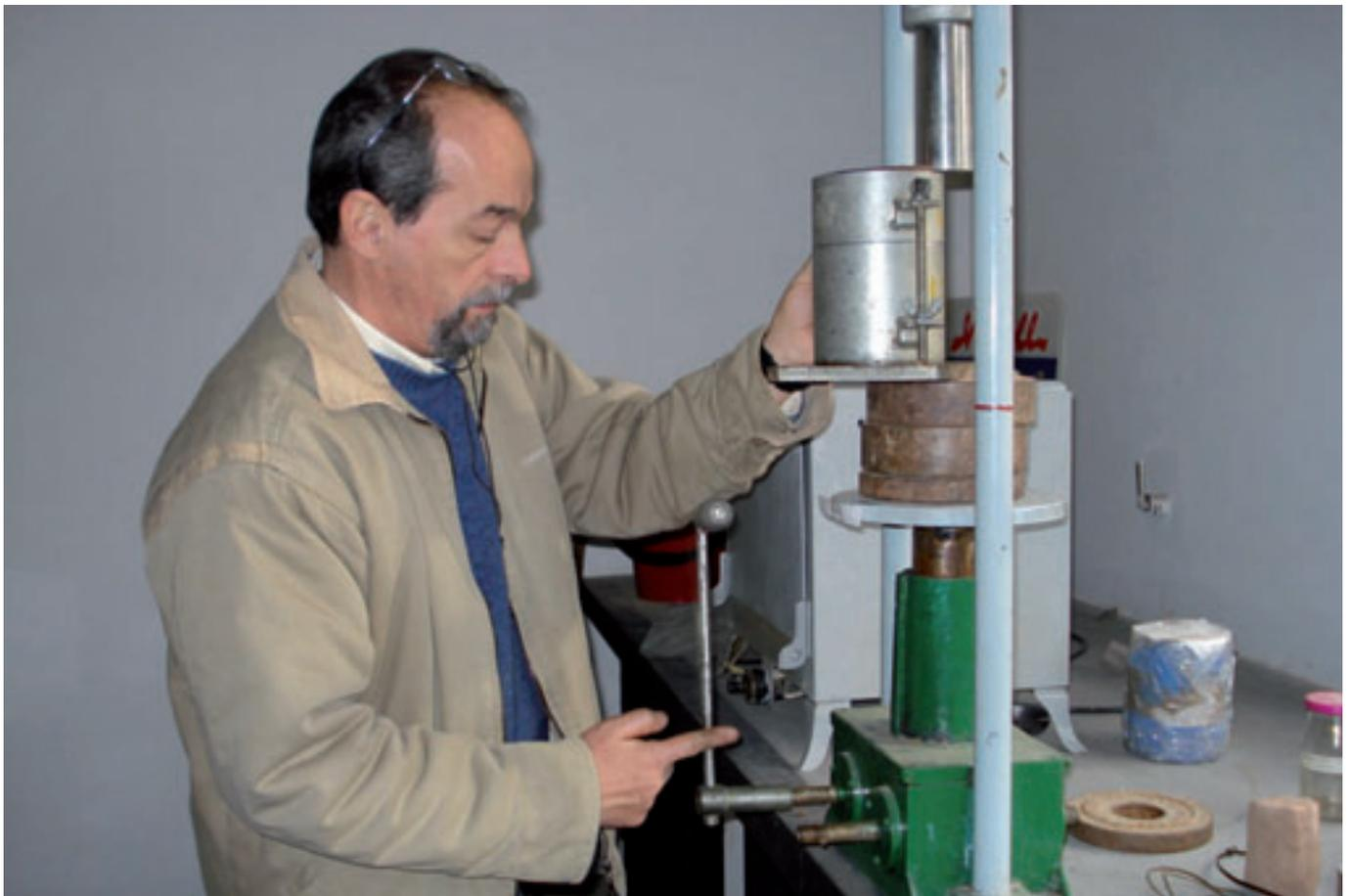
Figura 7. Fotografía preparación máquina CBR para Ensayo Proctor.
