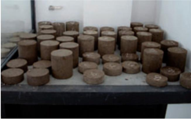
Figura 9. Fotografía Probetas de Tierra T I y T II.
