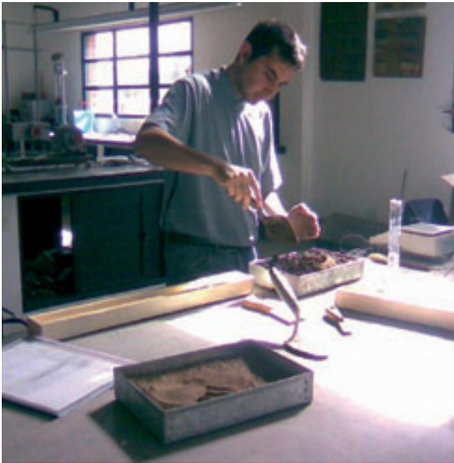
Figura 16. Fotografía preparación ensayo de Alcock.
