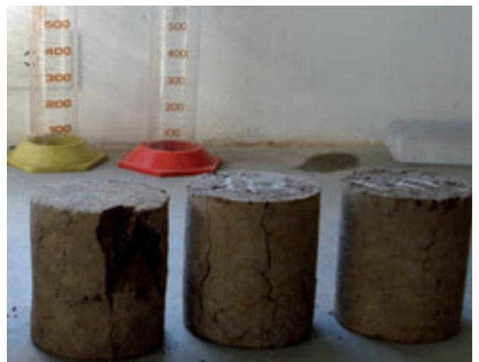
Figura 12. Fotografía probetas ensayadas a la compresión.
