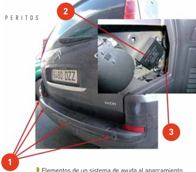
► Elementos de un sistema de ayuda al aparcamiento
