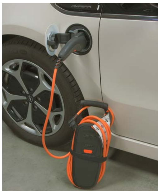
► Recarga doméstica de la batería de alta tensión del Opel Ampera
