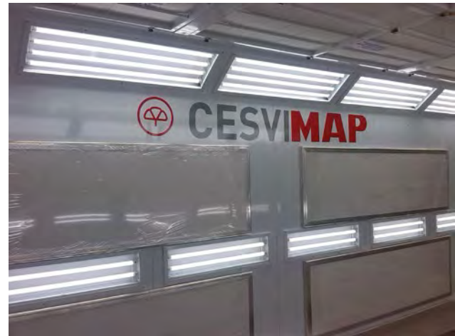
► Cabina con paneles endotérmicos
