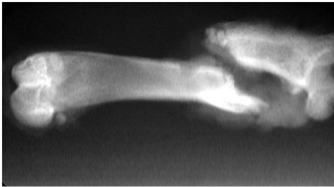
Figura 5. Fractura muy próxima al cóndilo femoral del espécimen nº 7 (grupo 2a) lado derecho. Se observan restos del carrier en el borde de la fractura. En la parte más distal de la fractura se observa el orificio control.
