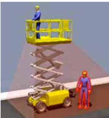
Figura 22. Control de presencia de operarios en proximidad.
