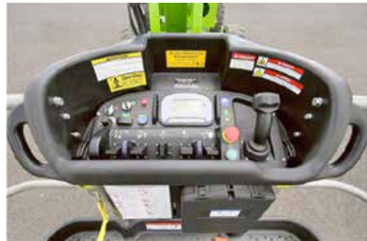
Figura 10. Mando primario sobre plataforma de trabajo.
