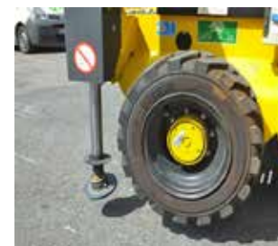
Figura 2. Base de apoyo de un estabilizador.
