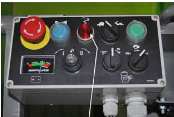
Figura 13. Indicador de alarma de señalización de inclinación máxima.
