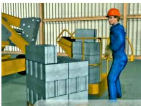
Figura 17. Plataforma de trabajo sobrecargada.
