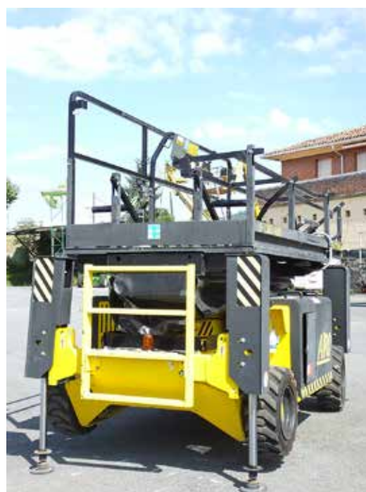
Figura 6. Plataforma de trabajo con protecciones perimetrales plegables.
