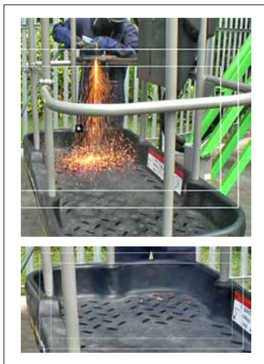
Figura 5. Base de la plataforma de trabajo autoextinguible.
