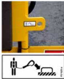
Figura 8. Señalización de punto de anclaje solo para retención.
