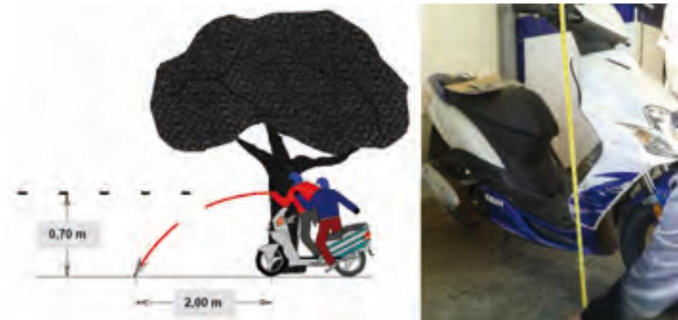
Figura 3. Desplazamiento post-colisión del Sr. X. Dos metros desde el punto de choque contra el árbol y a una altura de 0,70 metros, medida tomada en un ciclomotor de iguales características que el implicado.
