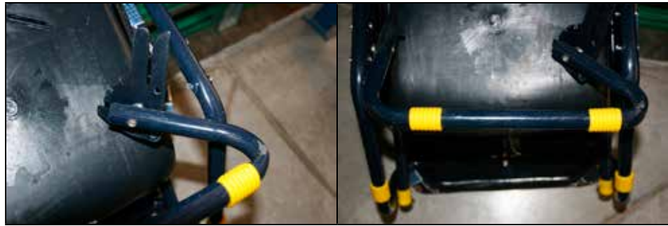
Figura 9. Imágenes del SRI no homologado después del ensayo
