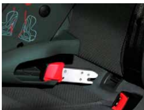
Figura 68. Ejemplo de sistema ISOFIX. A la izquierda la pinza metálica del SRI para anclarse al dispositivo fijado en el vehículo
