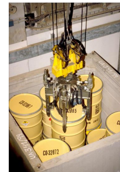
Equipo de manipulación de bidones, El Cabril (ENRESA)
