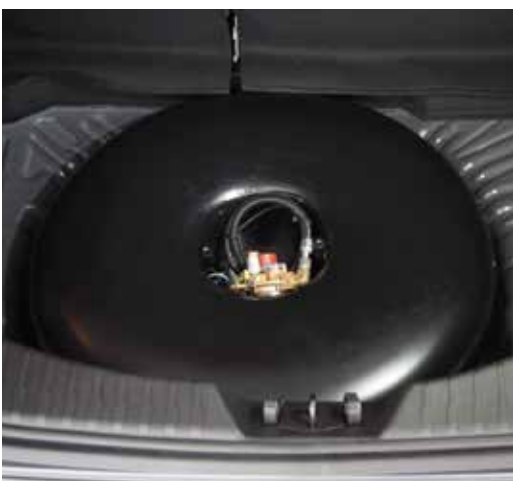
► Depósito de GLP
