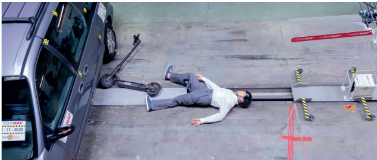
Crash test de un VMP Xiaomi Mijia contra un monovolumen, en CESVIMAP
