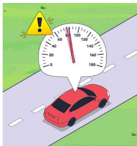
Figura 6. Se le advierte al conductor cuando el sistema detecta que excede de la velocidad máxima fijada
