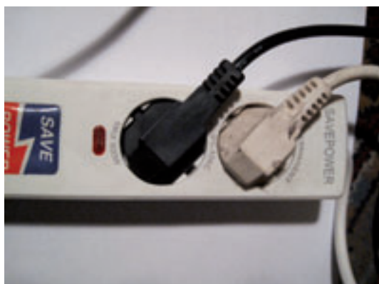
FIGURAS 4.3., 4.4., 4.5. y 4.6. Regletas de conexión con desconexión automática.
