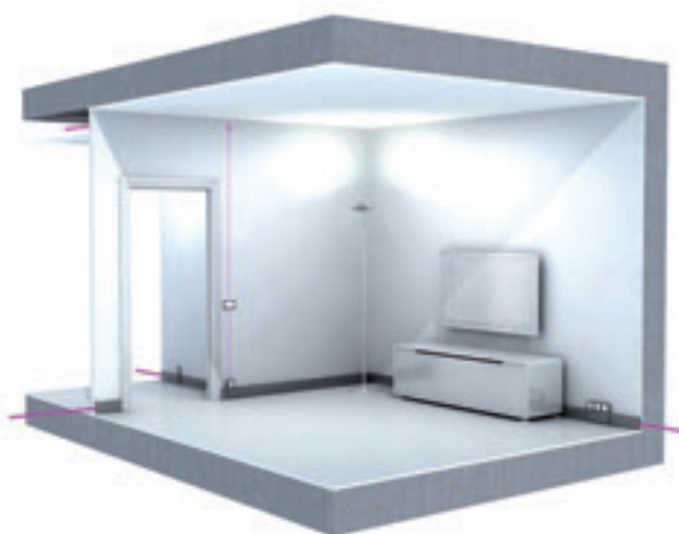
FIGURA 5.28. Colocación de toma de corriente y toma de TV sobre zócalo portacables.
