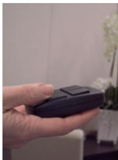
FIGURAS 5.54., 5.55. y 5.56. Control domótico de iluminación que se comunica por radiofrecuencia, sin necesidad de cables ni pilas (fijo y móvil) 74 .
