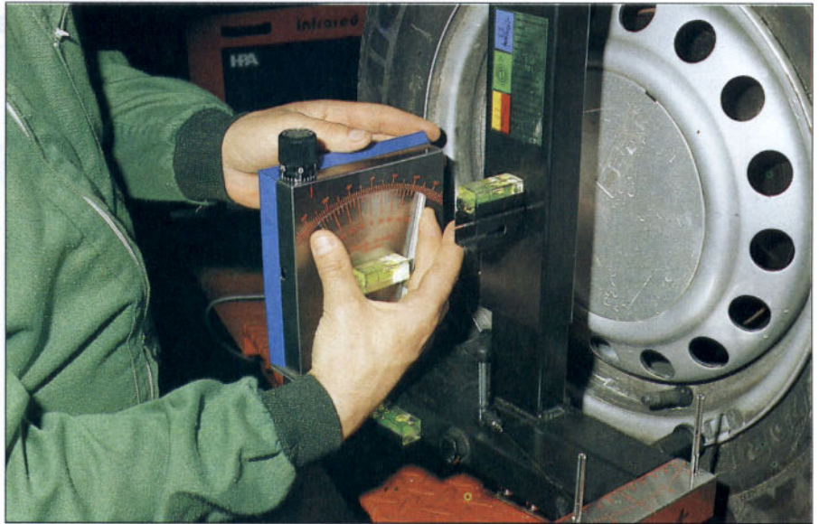
Medición del ángulo de caída.
