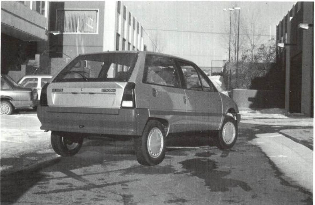
El material del portón trasero es un compuesto de resina de poliéster y cargas minerales, reforzado con fibra de vidrio. Portón y luneta ensamblan entre sí por medio de tres tornillos: uno de ellos, el central, es el eje del brazo del motor del limpiavientos; además, portón y luneta están pegados en varios puntos de la superficie de contacto entre ambos.
