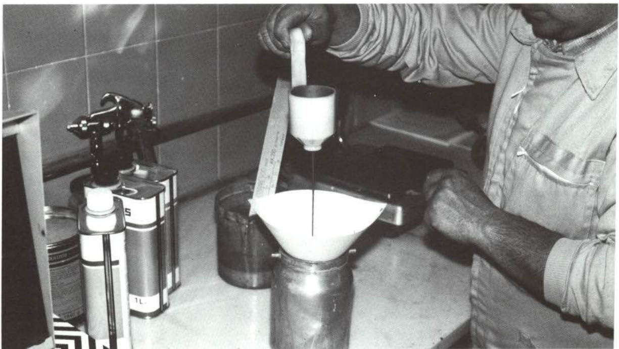
FOTO 3.—Comprobación de la viscosidad mediante la "Copa Ford".
