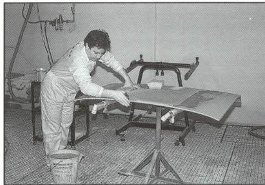
FIGURA 3.—Lijado con Scotch-Brite, limpieza con disolvente y acabado al agua.
