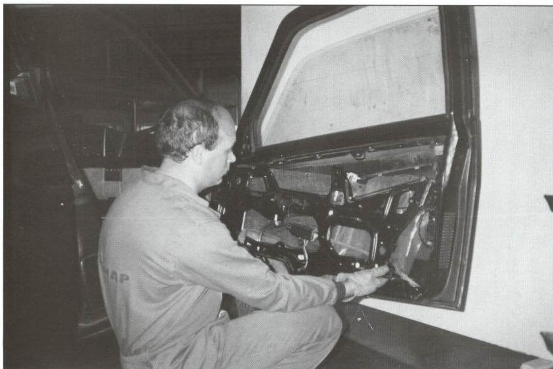
FIGURA 2.—Desmontaje del armazón.
