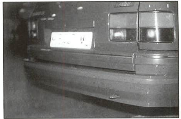
2.12. Aspecto del paragolpes reparado y pintado.
