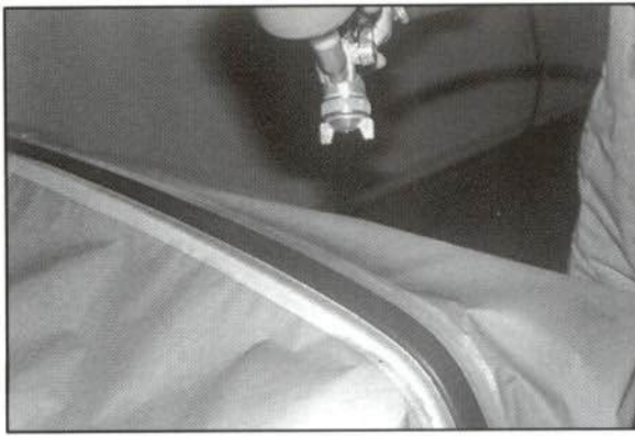
2.11. Aplicado el color base, se enmascara la pieza para pintar la banda de color gris.
