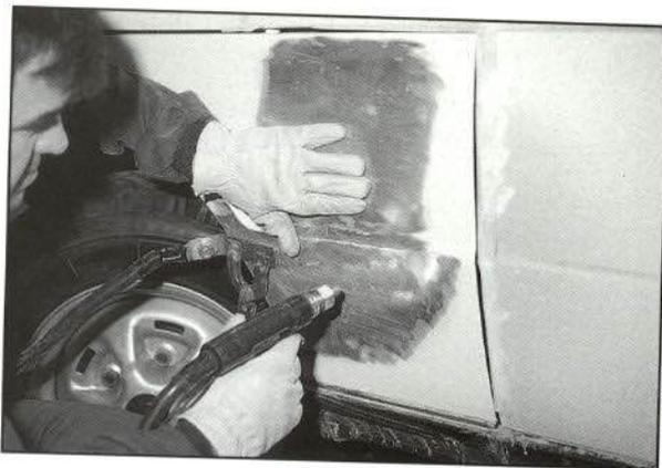
12. Eliminación de las pequeñas deformaciones haciendo uso del electrodo de cobre.
