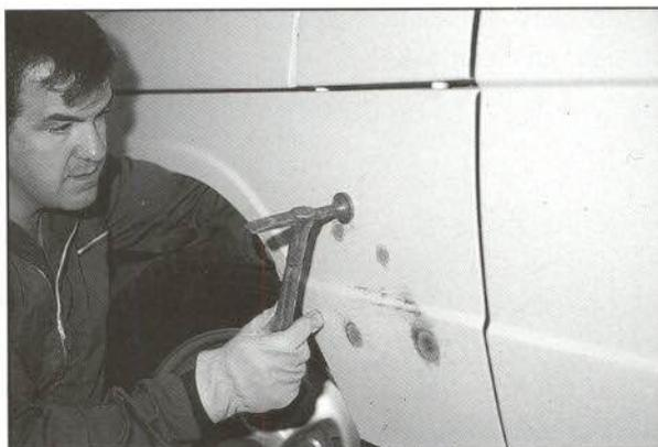
9. Suavizado de la chapa con lima de reparar para eliminar las tensiones generadas por la aplicación de calor.
