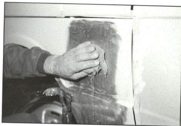
14. Eliminación de las tensiones creadas por el tratamiento térmico mediante un suavizado.
