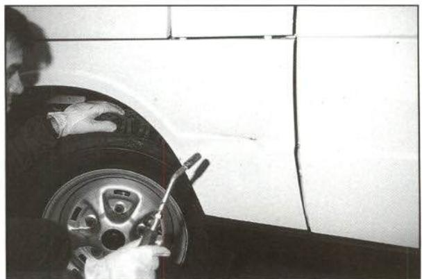
3. Recuperación de la mayor parte de la deformación con ayuda de una cuña hidráulica.
