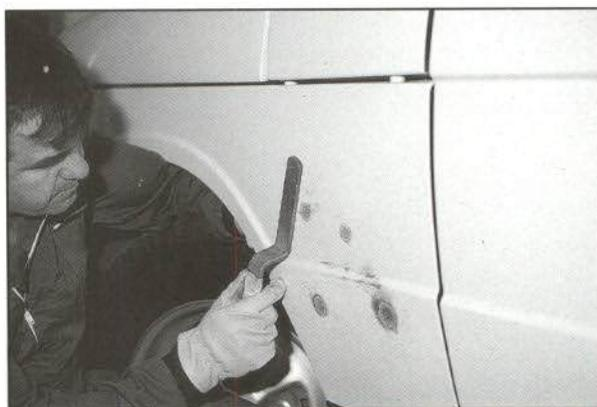
10. Eliminación de la capa de pintura con un disco de bajo poder abrasivo, tipo «Clean'n Strip».
