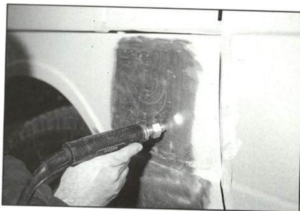
13. Enfriado posterior con agua, para mejorar las condiciones de retrainimiento en las zonas donde se aplica el electrodo.
