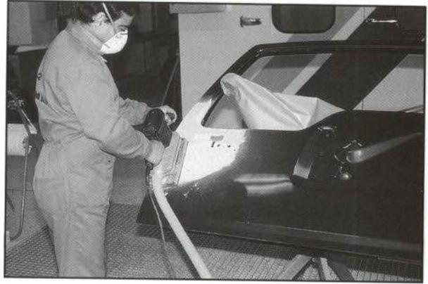
6. Mateado de brillo, en seco, del resto de la superficie con máquina excéntrico-rotativa con lija de grano P400 y, a continuación, con almohadilla abrasiva tipo «Scotch-Brite».
