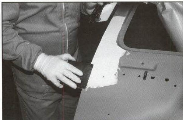
5. Tras 20 minutos de secado de la masilla de poliéster, lijado en seco de la misma con máquina vibratoria con sistema de aspiración y grano de lija P100, seguido de P120 y P150.
