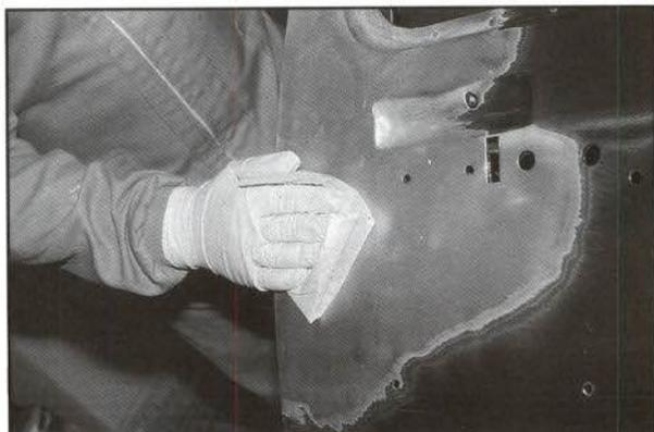
2. Lijado de los contornos de la zona reparada con máquina excéntrico-rotativa, con sistema de aspiración de polvo y grano de lija P-100, para rebajar el escalón existente entre el aluminio y la pintura original.
