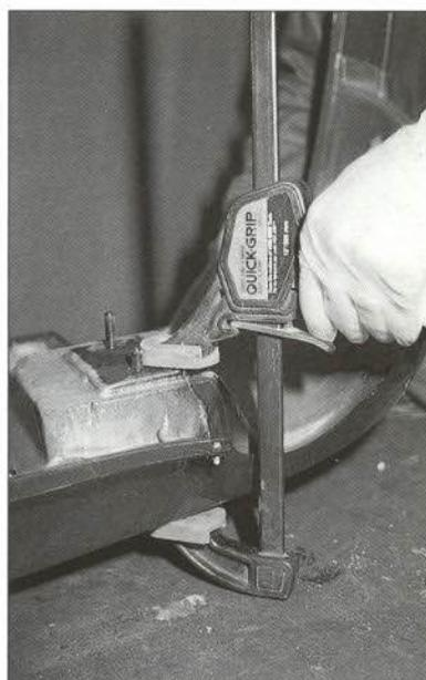
7. Posteriormente se elimina parte de la espuma por todo el contorno de la rotura y se sopla con aire para suprimir restos sueltos.
