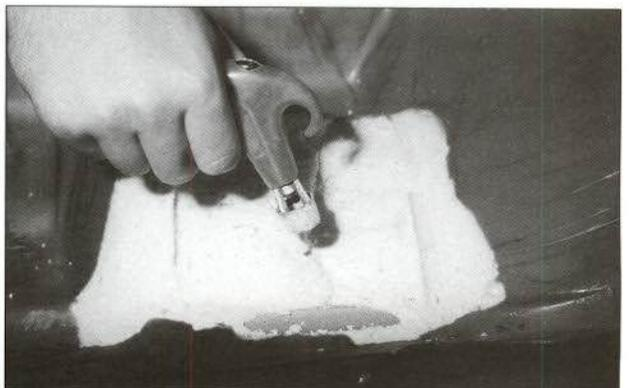
4. El adhesivo utilizado para la reparación es un sellador de poliuretano y su aplicación se realiza con la ayuda de una pistola de extrusión. El adhesivo se aplica sobre toda la superficie deteriorada.
