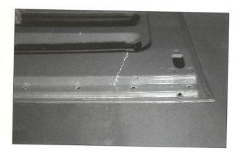
**8.** La reparación comenzará con un lijado de la zona dañada. En aquellas zonas no accesibles para la lijadora, se empleará una fresa.
