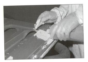
10. La reparación propiamente dicha se realizará mediante la aplicación de una argamasa hecha con resina de poliéster y fibra de vidrio cortada.
