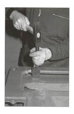
**3.** La conformación de la zona se realizará con tas y martillo, sustituyendo el martillo por la lima de repasar para las operaciones de acabado.
