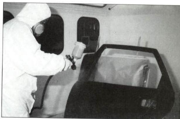
Figura 3.—Aplicación de la pintura.
