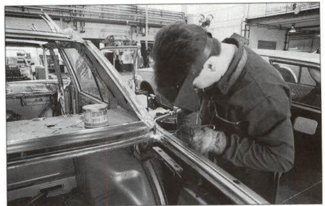
Figura 7.-Ejecución de una soldadura fuerte.
