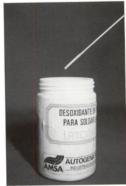
Figura 6.-Aplicación del fundente a la varilla.
