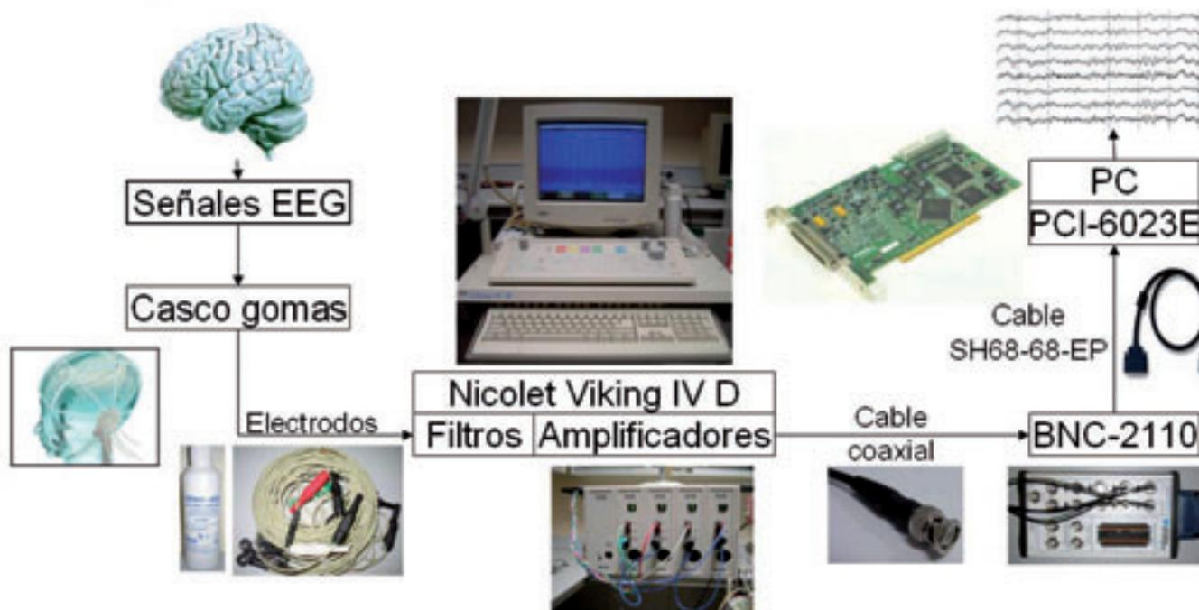
Figura 2. Arquitectura hardware del sistema de adquisición EEG inicial.
