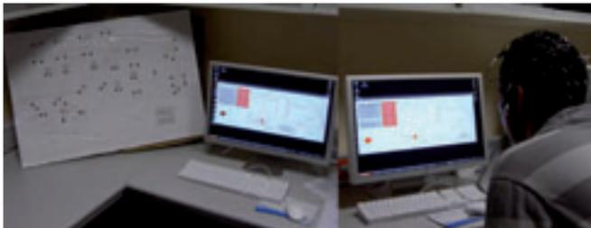
Figura 13. Interfaz del sistema domótico junto a la maqueta (izquierda) y usuario controlando el menú domótico con el equipo de adquisición de señales EEG (derecha).
