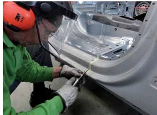
rápidos de desecho; usados de forma inadecuada pueden causar destrozos irreversibles en la chapa. Este tipo de trabajo resulta fatigoso y se efectúa solamente cuando no se pueden emplear otros métodos de corte.
