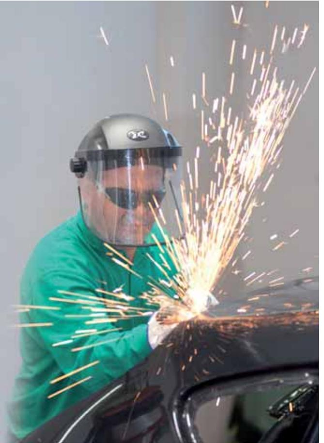
LA **SUSTITUCIÓN DE ELEMENTOS DAÑADOS** SE REALIZA CUANDO SU REPARACIÓN NO ES VIABLE TÉCNICA NI ECONÓMICAMENTE. EN LOS ELEMENTOS CON UNIONES AMOVIBLES, LA OPERACIÓN DE SUSTITUCIÓN NO SUELE PRESENTAR PROBLEMAS, PUESTO QUE CONSISTE EN DESMONTAR EL DAÑADO Y REEMPLAZARLO POR EL NUEVO. SI EL **ELEMENTO DE UNIÓN ES FIJO**, PARA SU SUSTITUCIÓN HAY QUE RECURRIR A DIVERSAS **TÉCNICAS DE CORTE Y DESGRAPADO**
