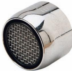
También pueden utilizarse reductores de caudal en grifos, que son dispositivos que se pueden incorporar en las tuberías de los lavabos, así como en las de las duchas de los vestuarios, para impedir que el consumo de agua exceda un consumo fijado (normalmente 8/10 litros por minuto). Si la instalación dispone de una baja presión, la calidad del servicio se puede ver perjudicada.
