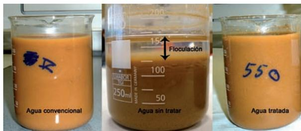
Resultados del test de floculación: Lodo generado con agua convencional (agua limpia), lodo generado con agua procedente del Filtro-Prensa, y lodo generado del Filtro-Prensa tratada. Fuente: IMDEA Agua.
