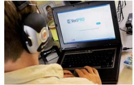
mina el Nivel de Atenuación Personal (PAR) proporcionado a cada empleado por los tapones. A diferencia de otros sistemas de verificación, VeriPRO funciona con cualquier tipo de tapón auditivo.
