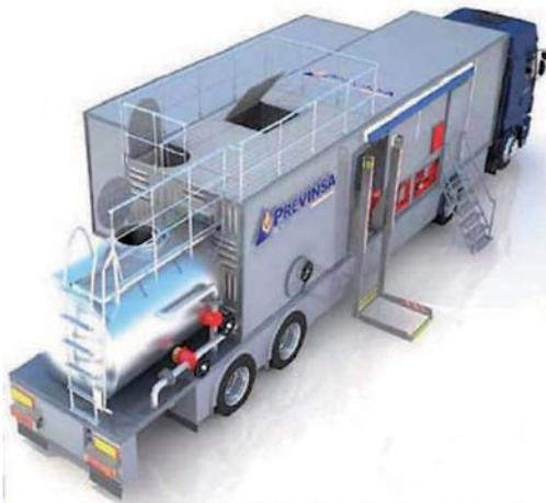
brida) y cinco simuladores de derrame (tres roturas diferentes de tanque, rotura de tubería y rotura de brida). La unidad está equipada con detectores de oxígeno, monóxido, amoníaco y propano, sondas de temperatura a distintos niveles y sistema de detección y alarma de incendios. Dispone de un amplio equipamiento y EPIS.
