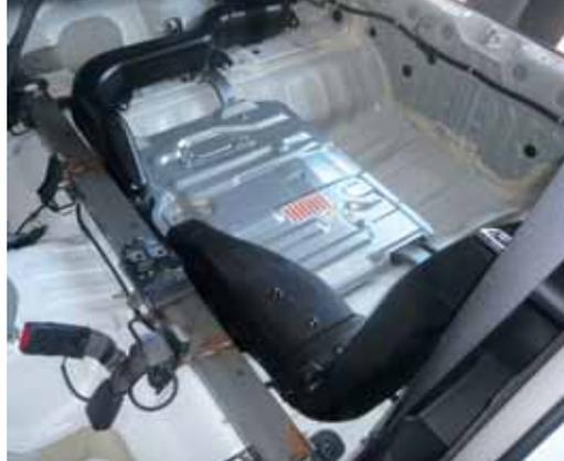
► Sistema de refrigeración de la batería
