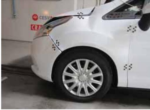
La carrocería está fabricada en acero reforzado en un 55% y en acero ultrarreforzado al boro en un 26%. Estos materiales aportan ligereza y, a la vez, mayor resistencia.
