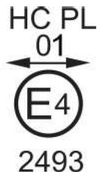
El faro que lleva esta marca de homologación tiene una lente de material plástico que cumple los requisitos del presente Reglamento referentes solo al haz de cruce y está diseñado:
