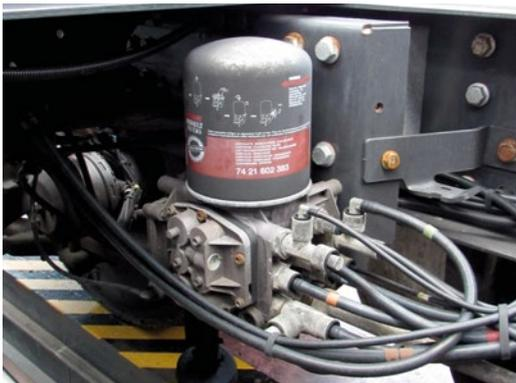
En el circuito neumático existe una parte común general para todo el sistema y que se encarga de generar el aire a presión, limpiarlo de impurezas y eliminar la humedad. Está formada por el compresor, el regulador de presión, el filtro y la válvula de protección contra fugas. Este sistema ha evolucionado desde los completamente neumáticos hasta los sistemas actuales compactos y con gestión electrónica, como el EAC (*Electronic Air Control*) de Knorr Bremse.
