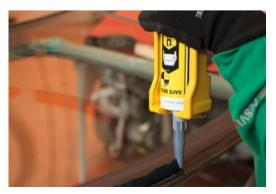
No se necesita imprimar las superficies de contacto, siempre que estén perfectamente limpias: el adhesivo, debido a su composición, ofrece una adherencia perfecta sobre los restos del anterior y sobre la cerámica de la luna o zonas pintadas.
