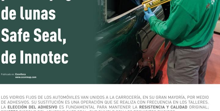
DE ADHESIVOS. SU SUSTITUCIÓN ES UNA OPERACIÓN QUE SE REALIZA CON FRECUENCIA EN LOS TALLERES. LA ELECCIÓN DEL ADHESIVO ES FUNDAMENTAL PARA MANTENER LA RESISTENCIA Y CALIDAD ORIGINAL: INNOTEC DISPONE DEL ADHESIVO SAFE SEAL, QUE CUMPLE CON LOS REQUISITOS EXIGIDOS
