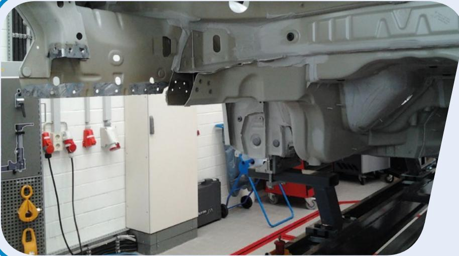
Desmontaje del travesaño trasero, que estaba unido a la carrocería de acero mediante adhesivo estructural y tornillos *flow drill*.
