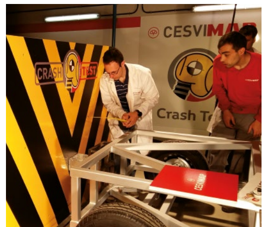
► Ensayo de atenuador de impactos para la Fórmula Student
