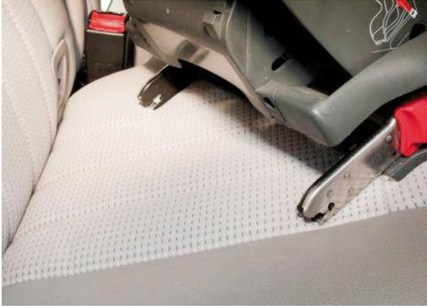
Las sillitas para bebés o portabebés se sujetan al coche bien mediante el cinturón de seguridad del vehículo o bien con el sistema ISOFIX (en el caso de que tanto la sillita como el vehículo dispongan de dicho sistema). El sistema ISOFIX facilita notablemente la tarea de instalar el portabebés o la sillita en el vehículo, aumentando así la eficacia del sistema.
