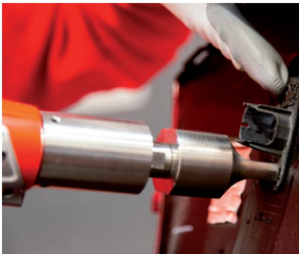
Soldadura por ultrasonidos con cabezal intercambiable
