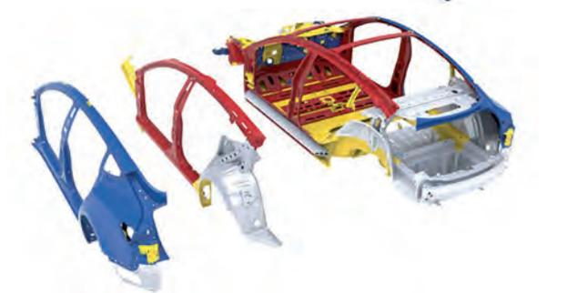
En gris, aluminio; azul, acero; amarillo, acero de alta resistencia y rojo, acero de ultraalta resistencia
