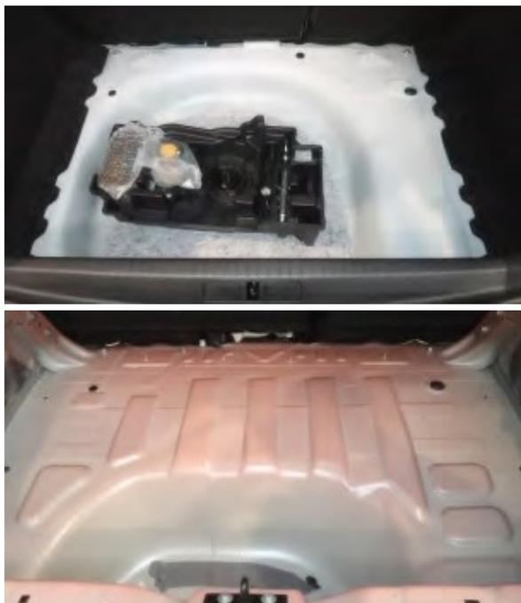
Arriba, hueco de rueda de repuesto del Corsa térmico.
