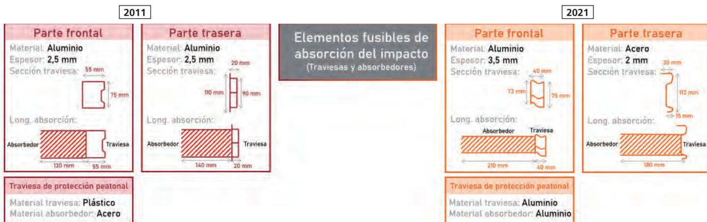
El caso ideal sería aquel en el que la actuación de las traviesas y los absorbedores hiciera que la energía transmitida a la carrocería fuera nula. Sin embargo, este hecho solo se da en colisiones a velocidades muy reducidas, ya que la energía que pueden absorber estos elementos es limitada, aun estando estos muy bien dimensionados.
