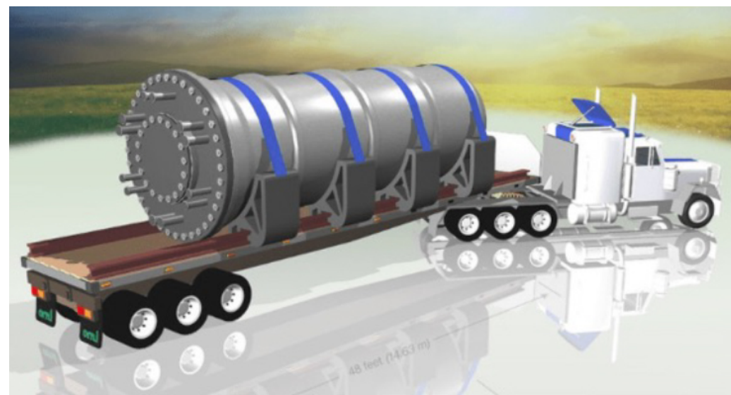
Representación conceptual del transporte de un reactor SMR por camión Fuente: Rolls Royce
