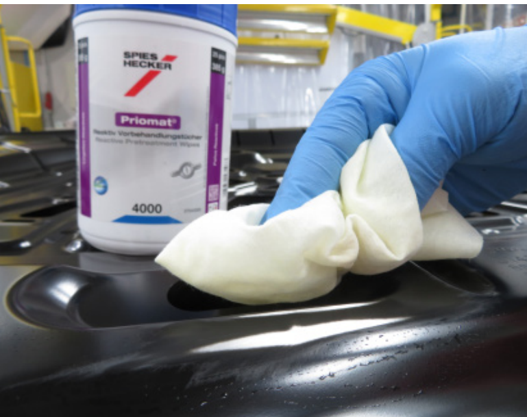
Bayeta impregnada de producto anticorrosivo
