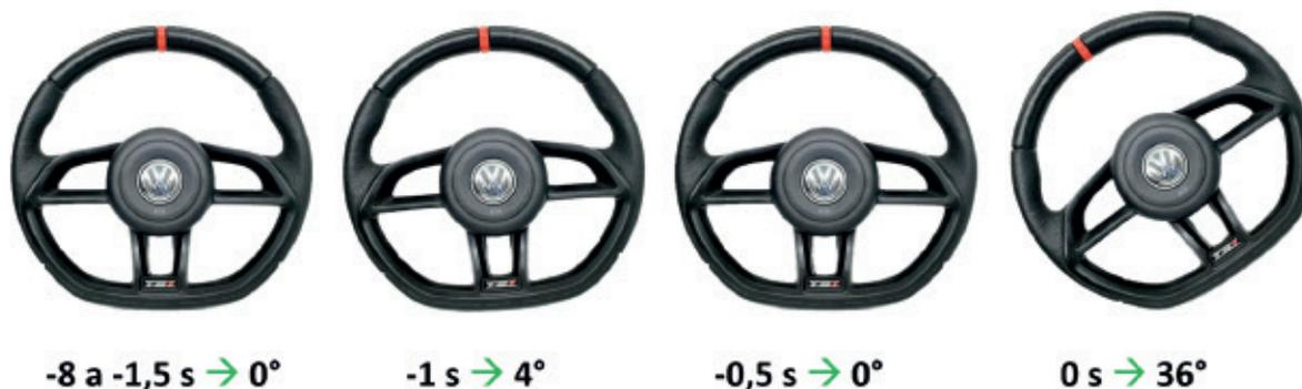
Esquema de giro del volante. El "volantazo" es de 36°, en el segundo -0,5 donde se activa el ESP
