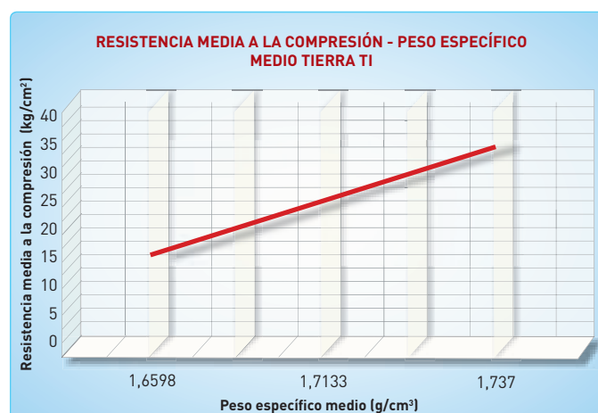
Figura 2a. Resistencia media a la compresión – peso específico medio – tierra T1.
