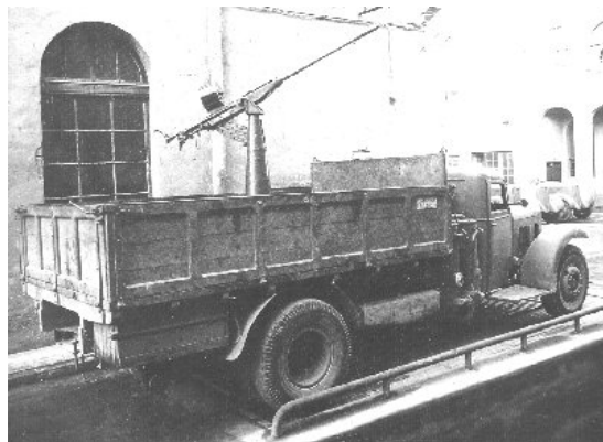
Ilustración 23: Camión modelo T-69, propulsado por gasógeno, con cañón antiaéreo Hispano Suiza
