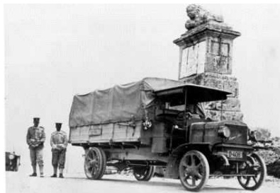
Ilustración 19: Camión militar con motor de 40 x 50
